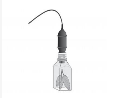
Senzor CO 2 napojený na biokomoru
